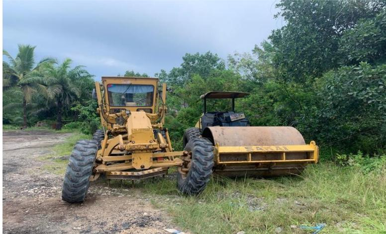
Gambar 1. Greder dan Roller compactor
